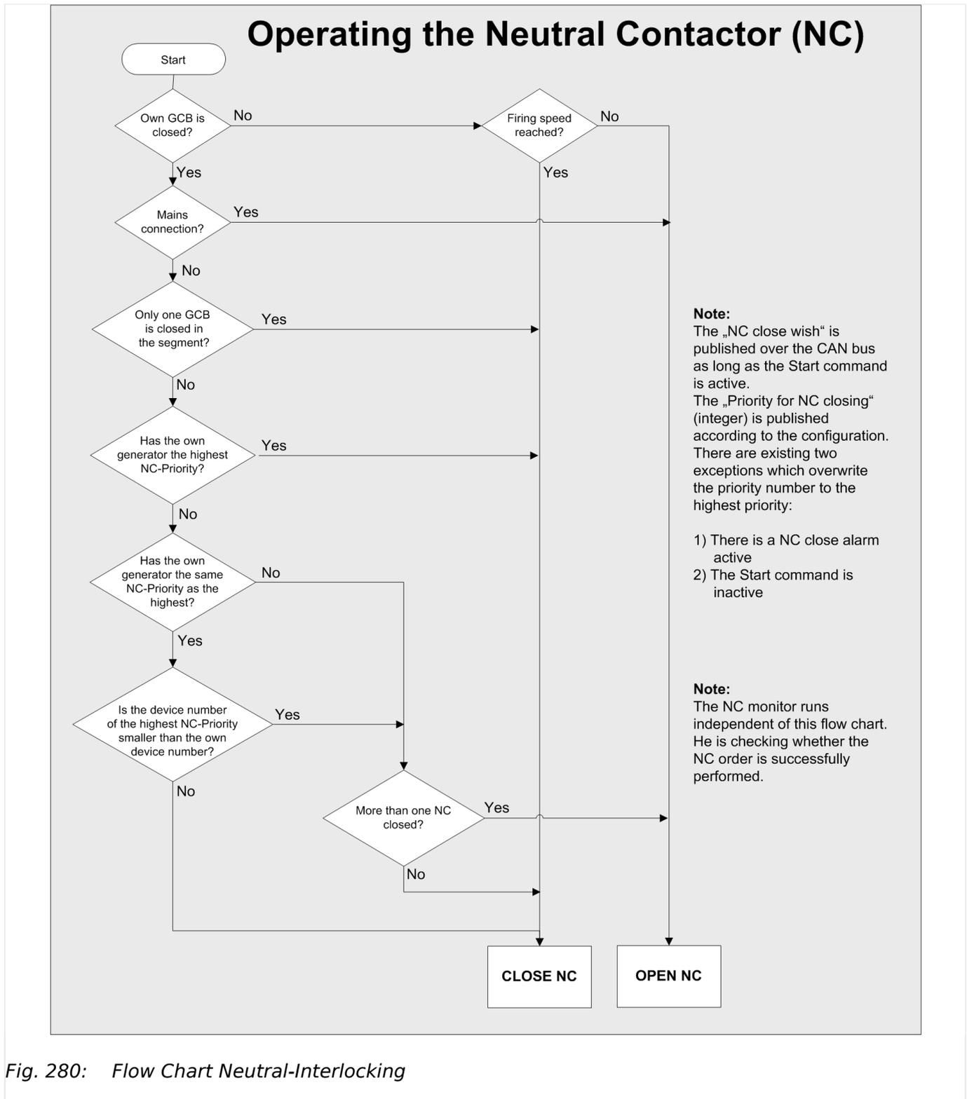
Fig. 280: Flow Chart Neutral-Interlocking
