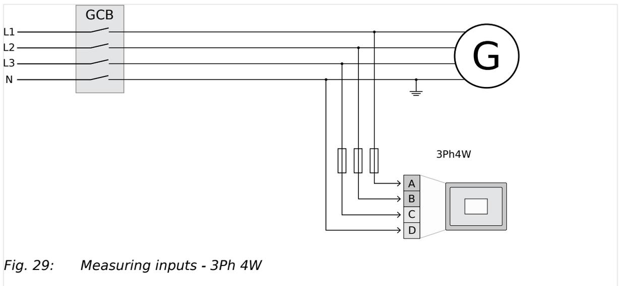
Fig. 29: Measuring inputs - 3Ph 4W
