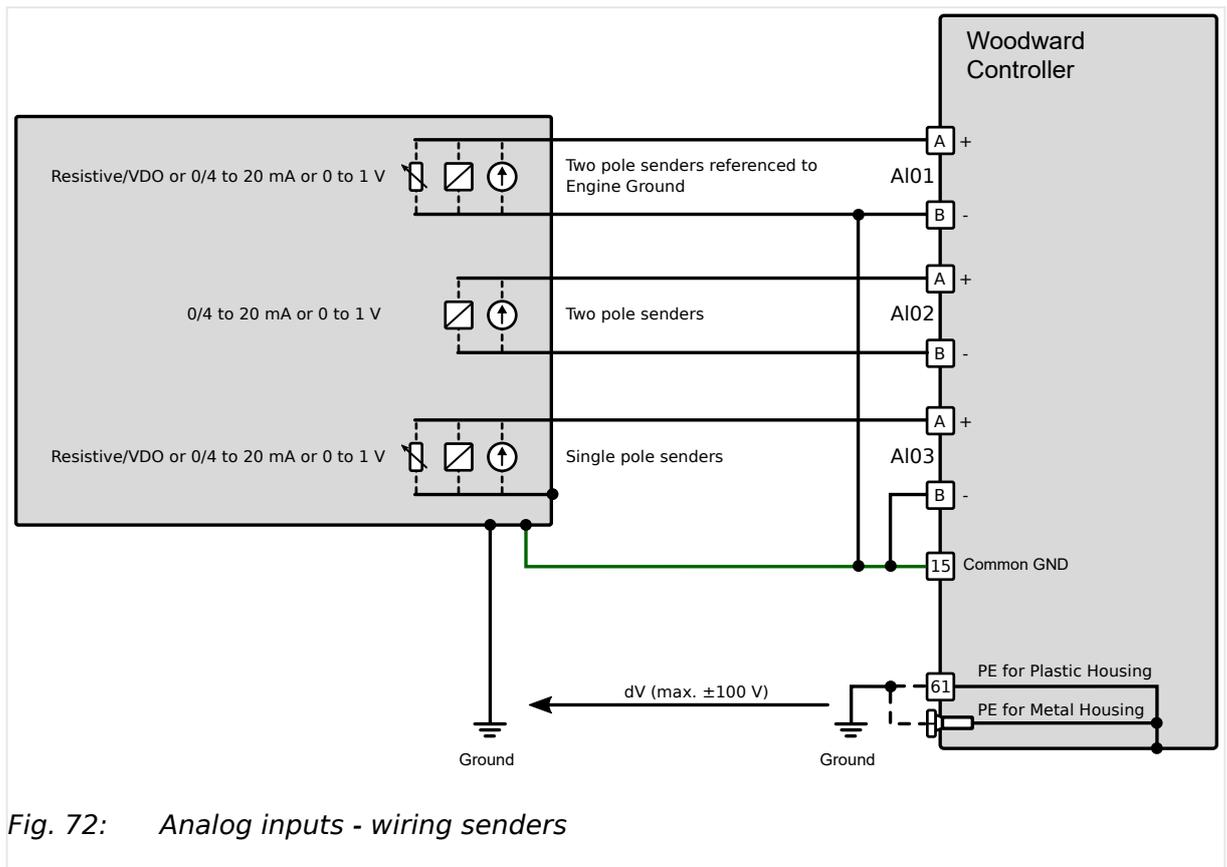
Fig. 72: Analog inputs - wiring senders
