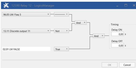
Fig. 237: LogicsManager function "Relay 12"
