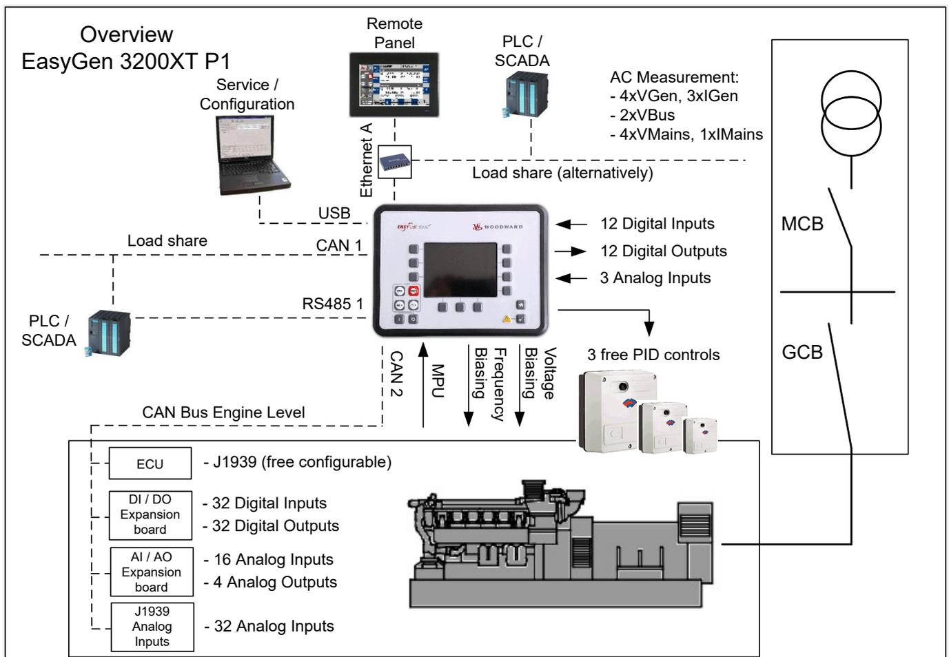
Fig. 205: easYgen-3100XT/3200XT-P1 communication interfaces
