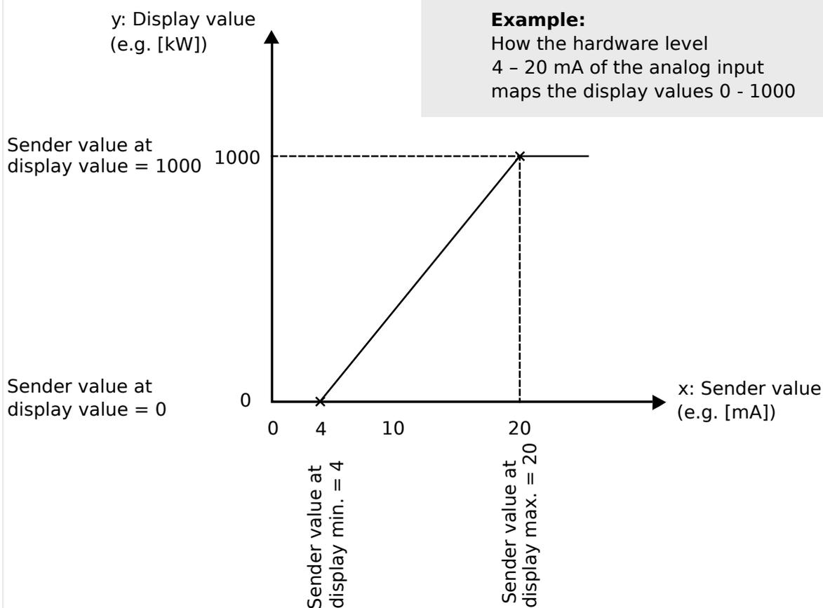
Fig. 158: Analog Input Mapping
