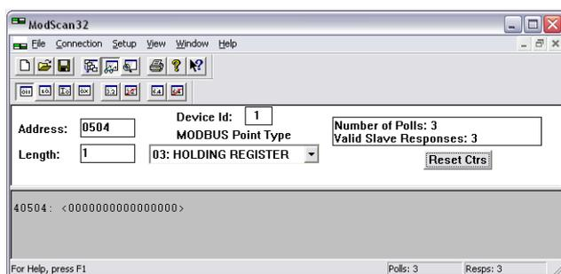
Fig. 292: Modbus - remote control parameter 503
