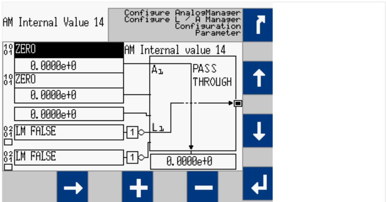
Fig. 210: Display (HMI) AM14
